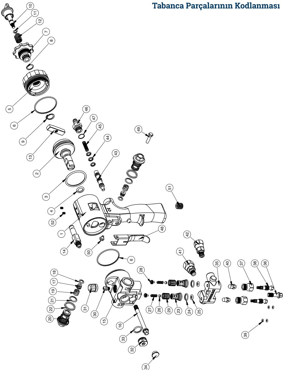
Şekil 7: Tabanca Parçalarının Ayrılmış Hali
